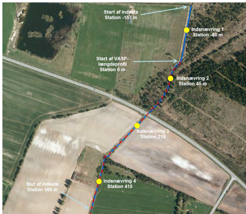
Figur 2-10 Forslag til placering af strømkoncentratorer langs indsatsstrækningen Ref. 603 langs den øvre del af Østerild Bæk.
